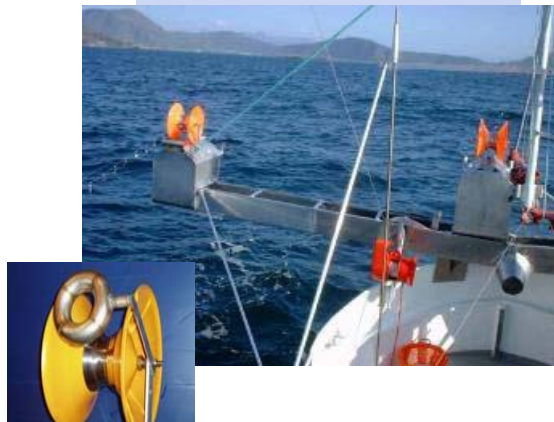
Makrellutstyr; rustfrie/syrefaste avriverkasser, renner, hjul, etc.
